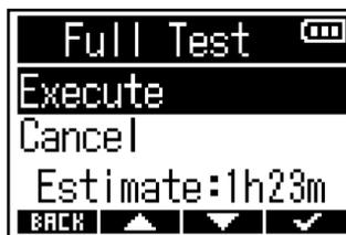
Результат проверки отобразится на дисплее. Если параметр Access rate MAX достигнет 100%, это означает, что карта памяти не прошла проверку.
