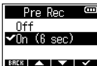
Доступное время захвата аудио до начала записи зависит от установленной частоты дискретизации. (→ [Частота дискретизации](#))
