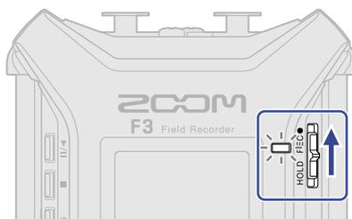
Запись начнется, индикатор REC загорится красным. Название, частота дискретизации и разрядность текущего файла отобразятся на дисплее.
